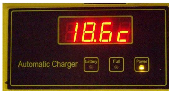
**4. Завершение зарядки.** FULL означает, что аккумулятор полностью заряжен и готов к работе. Вместе с надписью на дисплее загорается соответствующий индикатор Full.
