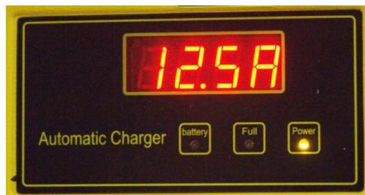
**3. Начало зарядки.** После самодиагностики ЗУ в автоматическом режиме переходит к процессу зарядки. На дисплее бегущей строкой отображается информация о напряжении аккумулятора в данный момент, токе, времени зарядки и уровне заряда в текущий момент.
