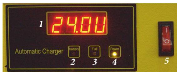
1. Дисплей: показывает процесс самодиагностики при включении, напряжение батареи, ток зарядки, емкость, время, окончание зарядки.
